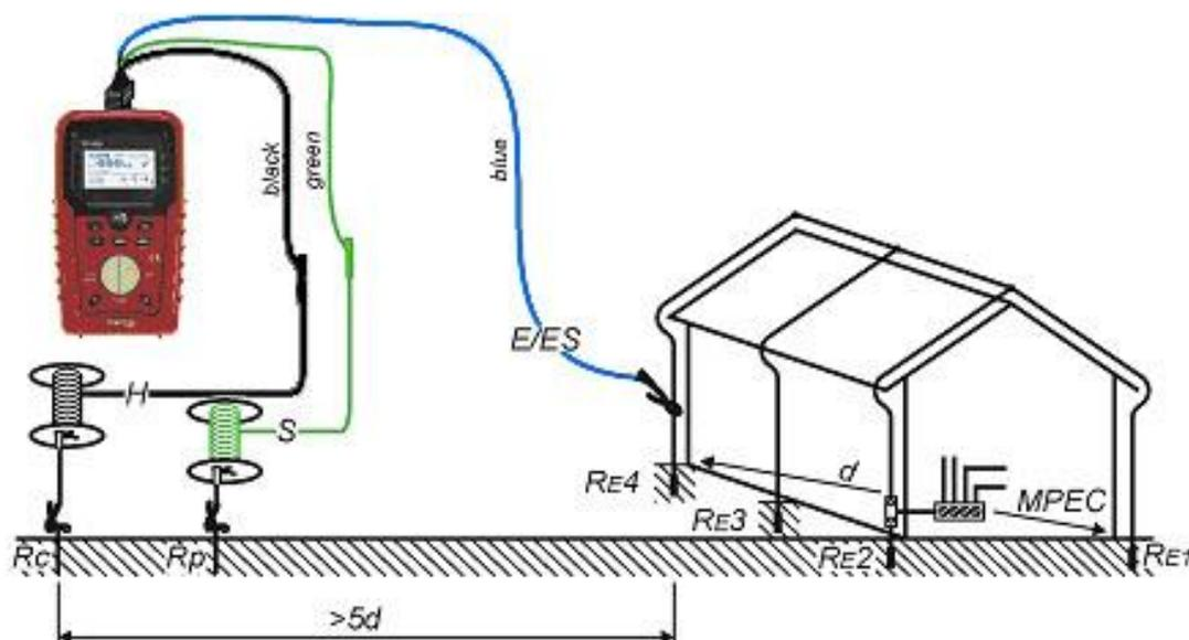
Bild 5.34: Widerstand zu Erde, Messung einer Blitzschutzanlage
