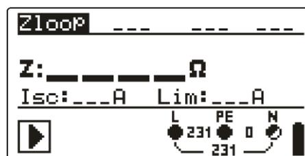
Bild 5.23: Fehlerschleifenimpedanz
